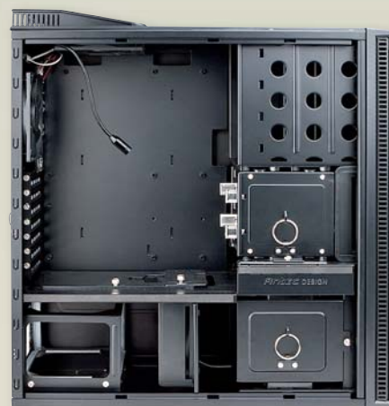
РАЗДЕЛЕНИЕ НА ОТСЕКИ способствует более эффективному охлаждению системы
